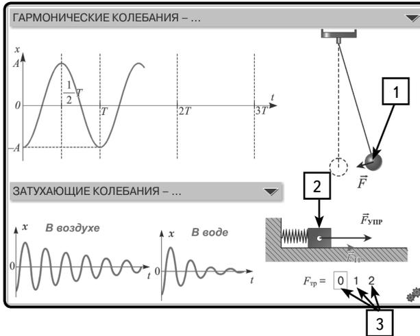
1 — шарик на нити, фиксированным нажатием LB шарик можно отвести от положения равновесия и отпустить, после чего он будет совершать свободные колебания. Синхронно с колебаниями шарика строится график  $x(t)$ .
